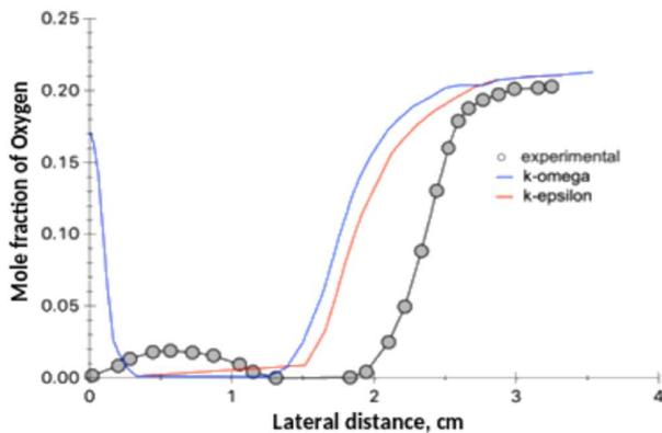
**FIGURE 10:** COMPARISON OF O<sub>2</sub> MOLE FRACTION
