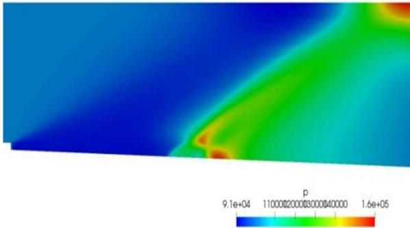
**FIGURE 16:** PREASSURE CONTOUR (27 STEP CHEM)
